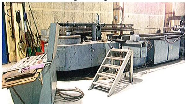
Maskin för bockning av ångrör, \varnothing 219,1 \times 18 mm.
